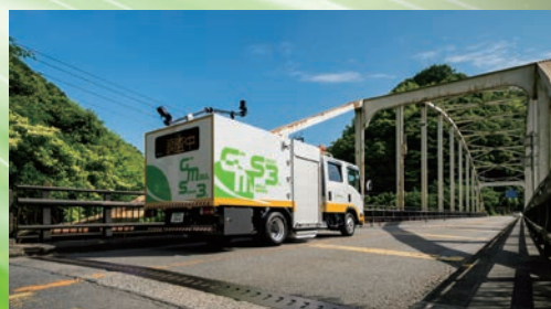
橋梁床板診断（鉄筋腐食・中空床板かぶり）
