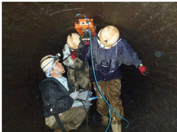
三朝水道TN_高さが1.39mしかない水道トンネルでのレーダ全員腰が壊れました。以降、入札には参加していません。
