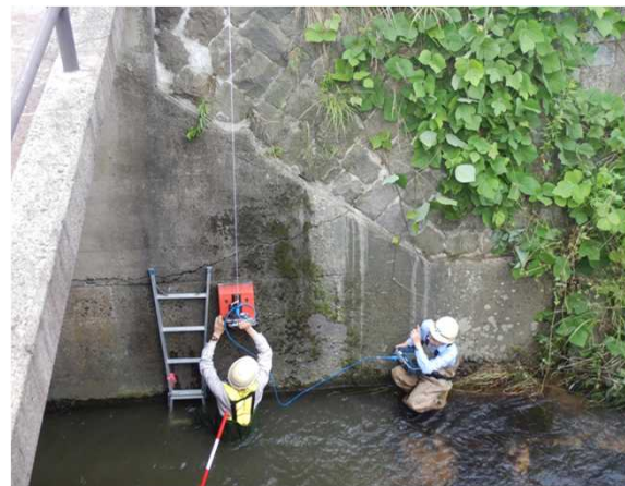
令和2年に島根県の国道9号で陥没が発生したのに伴い、その原因究明のための緊急調査擁壁背後の吸出しを把握すべく、道路面調査の徹夜明けに無理矢理レーダをしました。
