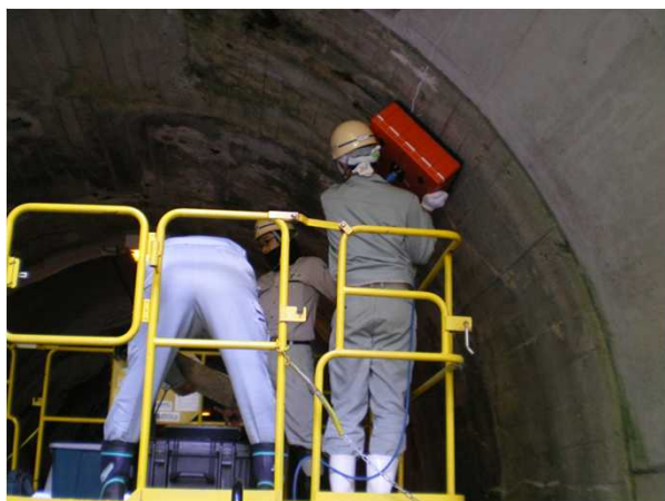
溝口TN_初めてレーダをした現場。アンテナが270MHzです。
